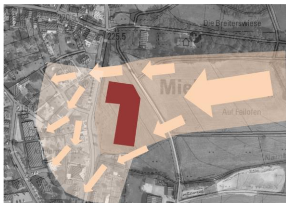
Abb.: Anzunehmender Luftstrom in die Siedlungslage in Abhängigkeit der Topografie nach Umsetzung der Planung
